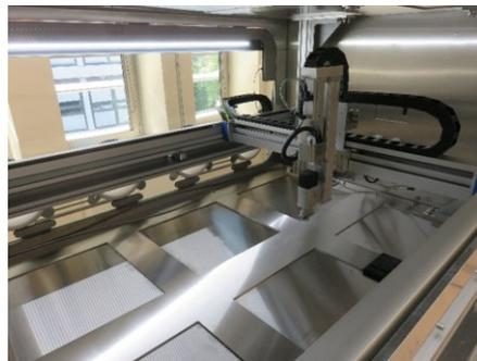
Flexible, modulare Fertigungsplattform für flüssigprozessierte Halbleiter-Dünnschichten
