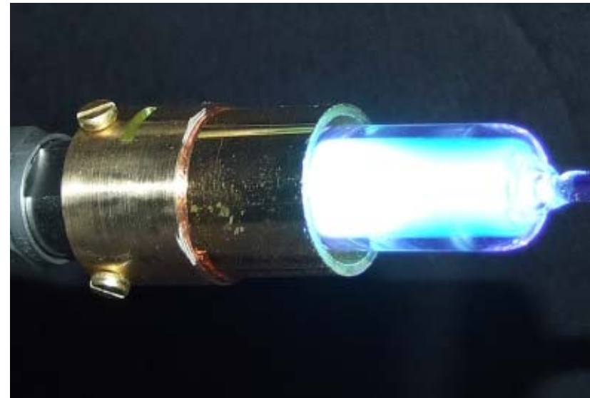
Quecksilberhaltige Lampe (ZnHg Amalgam) mit dem HF-Koppler im Betrieb
