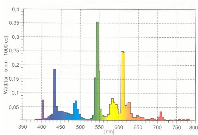
Spektrum einer Dreiband-Niederdruck-Leuchtstofflampe
