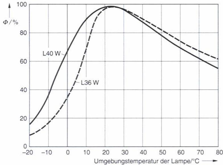
Lichtstrom in Abhängigkeit von der Temperatur für L36W und L 40W
